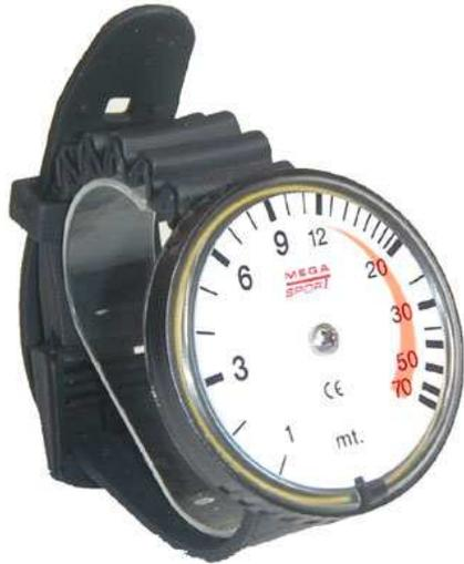
**Le Capillaire.** Il est constitué d'un tube de petit diamètre ouvert à une extrémité et rempli d'air. Il réagit suivant les applications de la loi Mariotte/Boyle. A l'immersion, l'eau pénètre dans le tube et comprime l'air. (*Voir le matériel de plongée – Les appareils de contrôle*).
